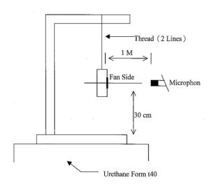
1 METER FROM MICROPHONE TO FAN INTAKE
