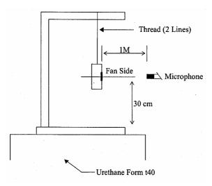
1 METER FROM MICROPHONE TO FAN INTAKE
