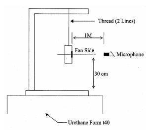
1 METER FROM MICROPHONE TO FAN INTAKE
